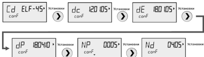
Рисунок 5.4 – Параметры конфигурации вычислителя
