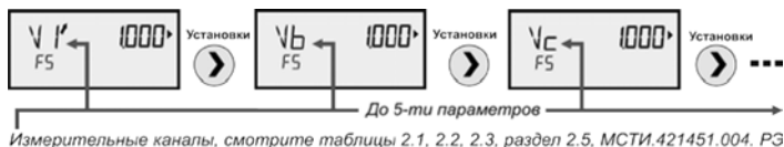
Рисунок 5.8 – Параметры веса импульса
